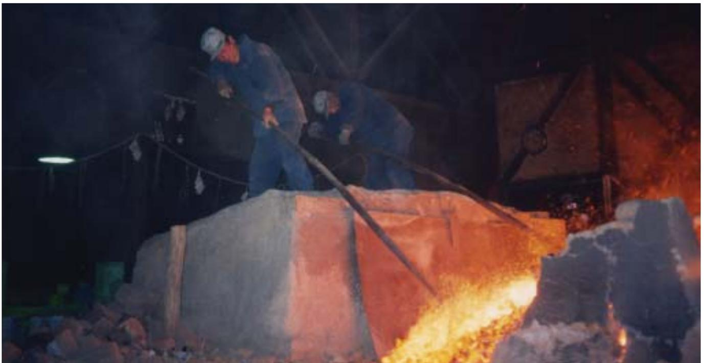
タタラ操業が終了し、大鍛冶〔村下・タタラの長〕が天秤山の上から炉を崩している。
